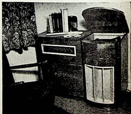
Luidsprekerkast met verstelbare klank-couliessen en reflectors. Deze combinatie, nakomertje op de MK Vormgevingsprijsvraag, werd gebouwd door dhr L. v. d. Werff te Kerkrade
